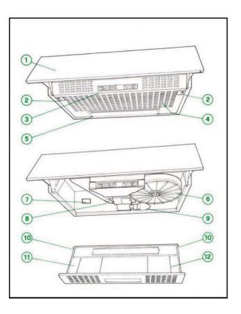
Questa cappa può essere utilizzata o ad evacuazione esterna (aspirante) o a riciclo interno (filtrante). È comunque possibile convertire la predisposizione iniziale anche ad installazione effettuata. Le migliori prestazioni si ottengono con la versione ad evacuazione esterna.
